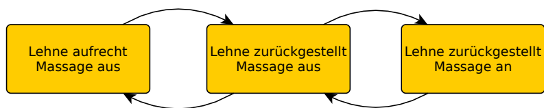
Abbildung 2: Dieses Zustandsdiagramm entspricht dem beobachteten Verhalten des Ausgangssystems, erfüllt jedoch nicht die Anforderungen an die Software. Bevor programmiert wird, müssen die Teilnehmer sich überlegen, wie sie den Zustandsraum erweitern und strukturieren möchten.
